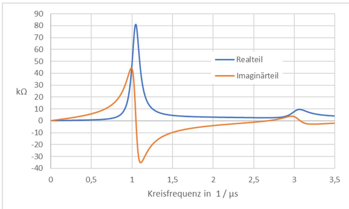
Obige Abbildung zeigt den Real- und Imaginärteil der modellierten Impedanz der untersuchten Spule.
