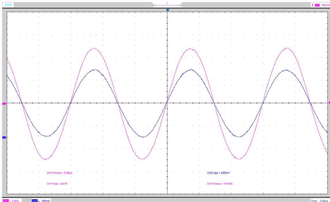
Bei einem Messwiderstand von  $1\ \text{k}\Omega$  wurden im Bereich bis 1 MHz drei Phasenresonanzen gefunden. Die Resonanzfrequenzen und die entsprechenden Verhältnisse aus Gesamtspannung zur Spannung am Messwiderstand sind nachfolgend aufgelistet:
