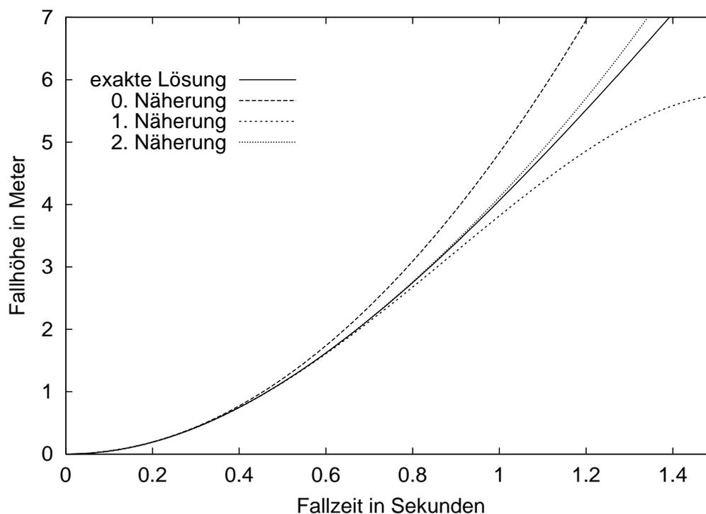
In der Grafik sind die exakte Lösung und die Näherungen der Fallhöhe als Funktion der Zeit mit den Parametern  $k = 0.13 \text{ m}^{-1}$  und  $g = 9.66 \text{ m/s}^2$  dargestellt. Die nullte Näherung gibt dabei das Fallen ohne Reibung an. Merkbliche Unterschiede zur exakten Lösung sind erst ab einem Meter Fallhöhe auszumachen. Bis zu einer Fallhöhe von zwei Metern hätte für die Rechnung die erste Näherung vollkommen ausgereicht.
